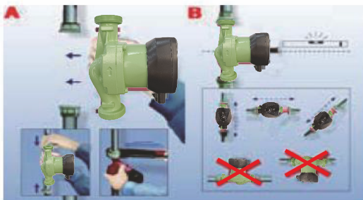
Rysunek 3: Montaż pompy cyrkulacyjnej z przetwornicą częstotliwości
